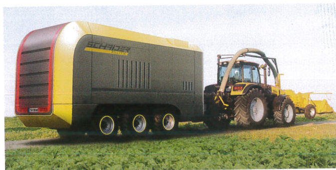
Pelletec D 8.0 nennt Schaidler seinen neuen Pellet-Vollernter, der 1 t Pellets für 33 Euro produzieren soll (bei 1 000 Betriebsstunden pro Jahr).
